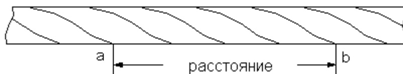
Рис. 9 Расстояние для определения выбраковки троса
